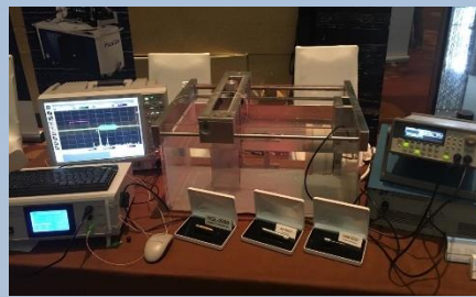
HFO-690 整体设置，包括光纤控制器，示波器，放大器，换能器，纤维水听器。
